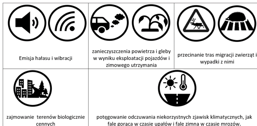
Rys. 5.4.1. Najczęściej występujące negatywne oddziaływania ulic oraz ich utrzymanie i ruch pojazdów na środowisko.
