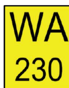
Rys. 10.2. Przykład tablicy informującej o połączeniu awaryjnym
