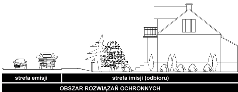
Rys. 9.1.1. Możliwości stosowania rozwiązań ochrony przed hałasem drogowym – obszar rozwiązań ochronnych [42]
